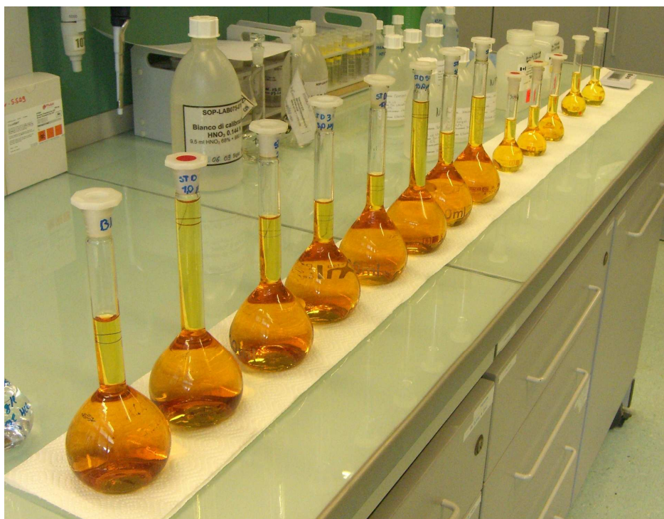
Figura 14: fotografia delle soluzioni standard e dei campioni scattata dopo i 10 minuti di permanenza a bagnomaria; si può notare che il volume delle soluzioni è aumentato confrontando il livello della soluzione con la linea che indica i 200 mL del matraccio.
