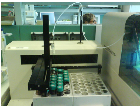
Fig. 1: Phoenix 8000, l'apparecchio utilizzato per rilevare la concentrazione di carbonio organico disciolto presente nella soluzione
