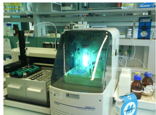
Fig. 1: Phoenix 8000, l'apparecchio utilizzato per rilevare la concentrazione di carbonio organico disciolto presente nella soluzione
